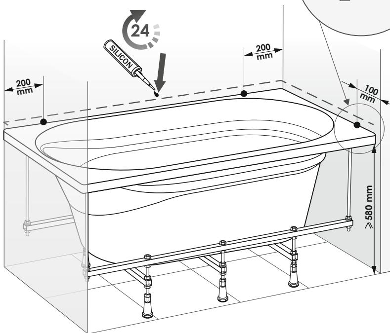
**Инструкция по монтажу акриловой ванны на металлический каркас**
